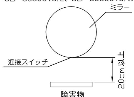
近接スイッチ側に反射率の高い障害物（鏡面、磁器の洗面台、ツヤ有仕上げのもの等）がある場合、また、設置する壁面の仕上げによって、指定以上の空間距離が必要になる場合があります。
