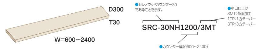
カウンターの奥行きは300mm、厚みは30mmのみとなります。カウンター全長600~2400mmの範囲内でフリーサイズで指定可能。水栓金具をカウンターに設置するアウトセットタイプの洗面ボウルもご使用頂けます。
