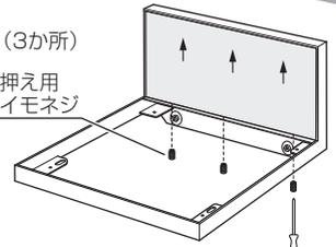
※バックガードを取り付ける際は、フレームとバックガードに段差ができないようにしてください。
