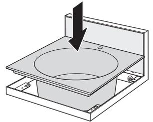
②レベル調整用イモネジを取り付け、洗面ボウルのレベル調整を行います。(4か所)
