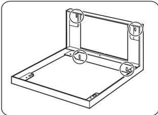
②上2つの下穴にはアンカープラグ小を、下2つの下穴にはアンカープラグ大とアンカーボルトを打ち込みます。
