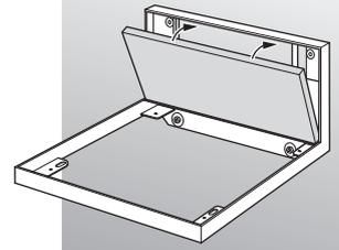
②バックガードを押し上げながら押え用イモネジで固定します。(3か所)
